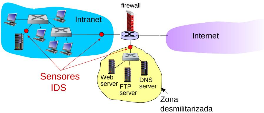
El switch replica todo su tráfico en una boca. Allí se instala el IDS.
