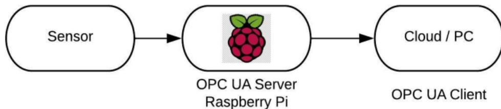
**Figura 2:** Flujo de transporte de datos desde el sensor hasta el dispositivo receptor
