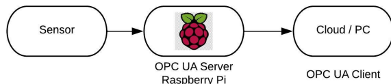
Fig. 7: flujo de transporte de datos desde el sensor hasta el dispositivo receptor
