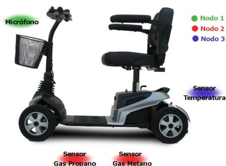
Fig. 1. Ubicación de los nodos de la red de sensores inalámbricos
