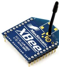
Fig. 5. Módulo XBee
