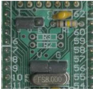
Poner el jumper de selector de alimentación JVE (JTAG – Vcc – Externo) en J-V para alimentar el microcontrolador (uC) desde el JTAG. De esta manera no es necesario conectar una fuente de poder para alimentar el uC. El JTAG provee 3.0V, pero una corriente muy baja, ya que es obtenida de los buses de datos del puerto paralelo.
