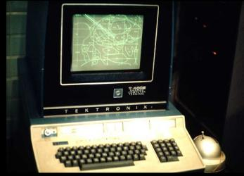
La imagen muestra una computadora PDP-12 durante una operación. Un plotter permitía respaldar las imágenes del procedimiento. Un terminal Tektronix, permitía visualizar una imagen de 1024x768 pixels con una frecuencia de actualización de 3-5 segundos.
