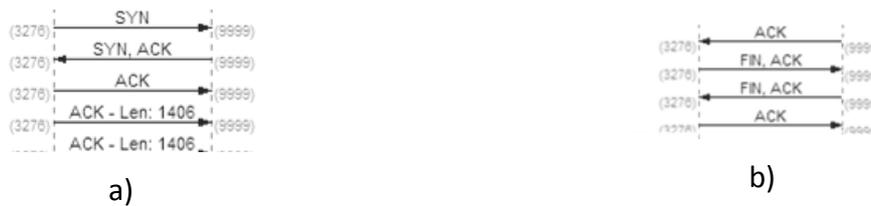
Figura 1: Diagrama de flujos de una conexión TCP. a) Establecimiento de conexión. b) Final de conexión.
