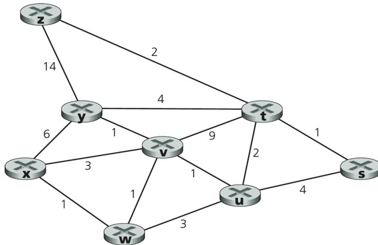
7. En cada iteración del algoritmo de Dijkstra se selecciona el nodo de menor distancia. Considere el problema anterior u otro basado en la misma red, para analizar cómo cambia la solución al tomar un nodo u otro cuando hay dos con igual menor costo en una iteración del algoritmo.
