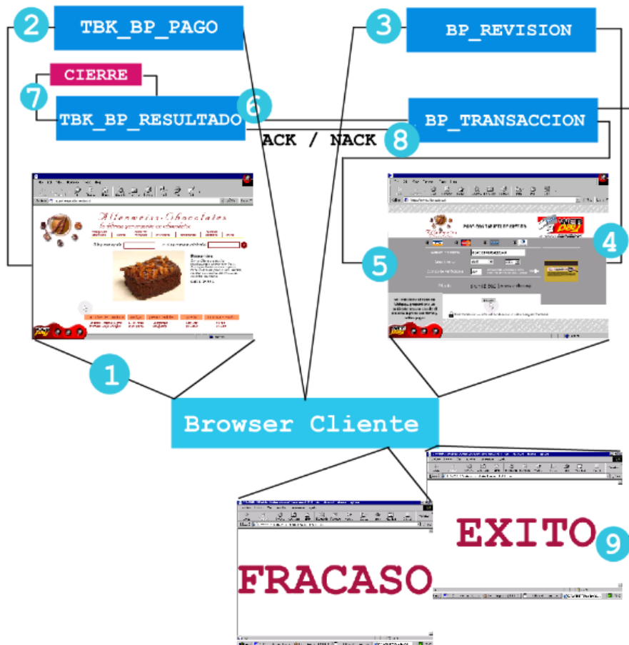
Figura 3: Secuencia que usa el servidor de comercio con el servidor transbank
