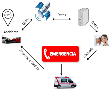
Figure 5. Funcionamiento del sistema con enlace satelital
