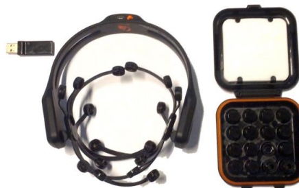
Figura 1. Kit de Emotiv Epoc, con el casco multicanal y los 16 sensores.
