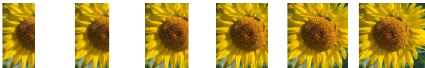
Figura 7.12 Ilustração de uma transição de entrada type “barWipe”, subtype “leftToRight”, startProgress “0.5”, que apresenta a imagem inicialmente já a 50% do progresso total da transição.
