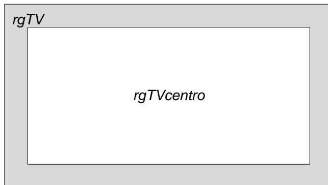
Figura 6.1 Leiaute de exemplo com uma região (“rgCentro”) centralizada sobre uma região pai (“rgTV”).
