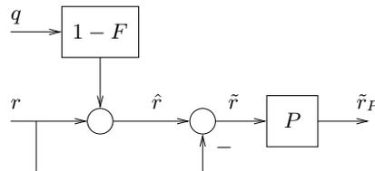
Figura 5: Modelo equivalente de un cuantizador realimentado.
