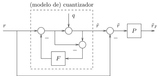
Figura 4: Modelo simplificado de un cuantizador realimentado.
