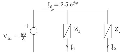
Figure 2: Equivalente por fases para el Problema 2.
