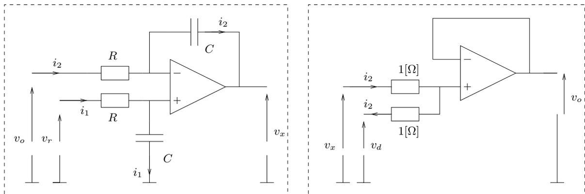
Figure 6: Circuitos aislados asociados a cada uno de los amplificadores operacionales del Problema 4.
