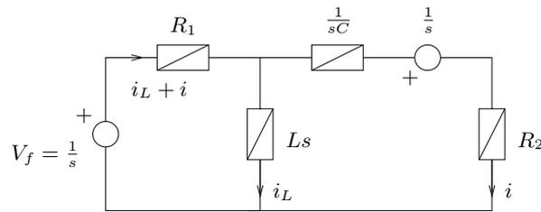
Figure 4: Equivalente en el plano de Laplace de la red del Problema 3.
