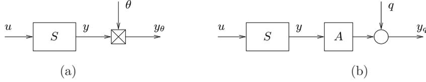
Figura 3: (a) Sistema en que la medición de la salida es intermitente y (b) situación auxiliar en que la pérdida de datos se ha reemplazado por una ganancia y una fuente de ruido.
