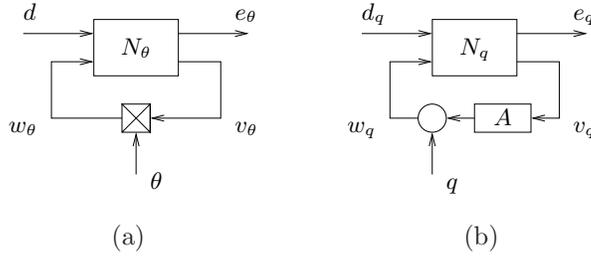
Figura 4: (a) Sistema realimentado a través de un canal imperfecto que pierde datos con probabilidad  $1 - p$  y (b) situación auxiliar en que la pérdida de datos se ha reemplazado por una ganancia y una fuente de ruido.
