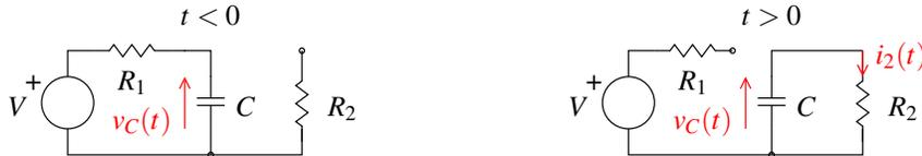
Para  $t < 0$ , la corriente por  $R_2$  claramente es cero. En la malla izquierda, aplicando LCK, LVK y ley de componentes se obtiene la ecuación diferencial
