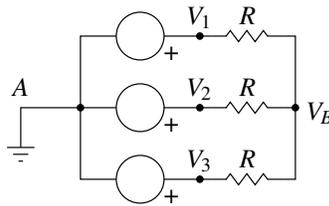
Sin embargo, 3 de los 4 voltajes de nodos están determinados por la fuente de voltaje por tanto, basta plantear LCK en el nodo B:
