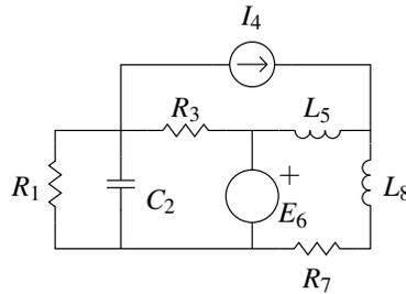
**Problema 2.2 (10 puntos)** Para la red de la figura, determine qué método, voltajes de nodo o corrientes de malla, da origen a un sistema de ecuaciones de menor dimensión (no es necesario formular las ecuaciones). Fundamente claramente su respuesta.
