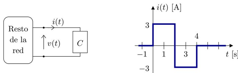
**1.4.1** Determine y grafique la potencia instantánea  $p(t)$  absorbida por la componente  $C$ .
