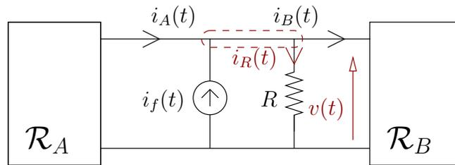
Aplicando LCK (en la superficie cerrada indicada con línea punteada) se obtiene  $i_R(t) = 4 \text{ [A]}$ . Luego, por ley de Ohm,  $v(t) = Ri_R(t) = 16 \text{ [V]}$ . Entonces la potencia entregada por la red  $\mathcal{R}_A$  es  $v(t)i_A(t) = 80 \text{ [W]}$ ; en cambio, la red  $\mathcal{R}_B$  recibe  $v(t)i_B(t) = 48 \text{ [W]}$ .
