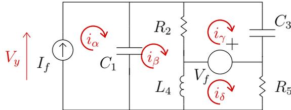
$$\begin{bmatrix} \frac{1}{C_1}D^{-1} & -\frac{1}{C_1}D^{-1} & 0 & 0 \\ -\frac{1}{C_1}D^{-1} & \frac{1}{C_1}D^{-1} + R_2 + L_4D & -R_2 & -L_4D \\ 0 & -R_2 & R_2 + \frac{1}{C_3}D^{-1} & 0 \\ 0 & -L_4D & 0 & L_4D + R_5 \end{bmatrix} \begin{bmatrix} i_\alpha(t) \\ i_\beta(t) \\ i_\gamma(t) \\ i_\delta(t) \end{bmatrix} = \begin{bmatrix} V_y(t) \\ 0 \\ -V_f(t) \\ V_f(t) \end{bmatrix}$$
