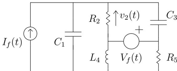
2.5.1 [20 pts.] Determine un sistema de ecuaciones consistente que permita analizar la red y fórmelo en forma matricial. NO DEBE HACER TRANSFORMACIONES EQUIVALENTES. No se pide resolver el modelo matemático
