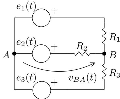
2.4.1 [10 pts] Determine un sistema de ecuaciones consistente que permita analizar esa red.
