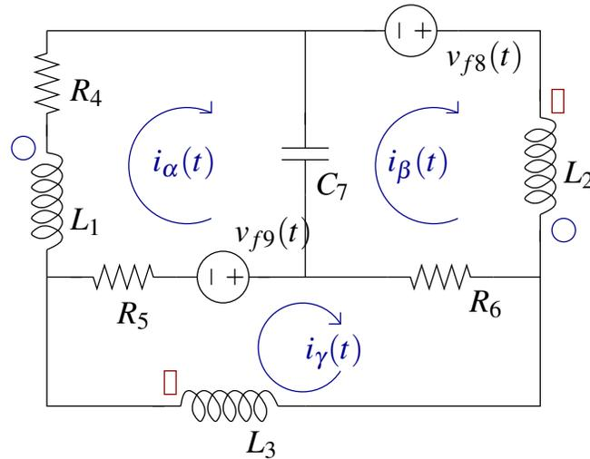
Si se aplica el método de mallas, SIN CONSIDERAR LOS ACOPLAMIENTOS, se obtiene la siguiente ecuación:
