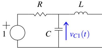
Donde fácilmente se aprecia que, en estado estacionario,  $v_{C1}(t) = 1$ , es decir, el condensador se carga hasta alcanzar al voltaje de la fuente que es continua.
