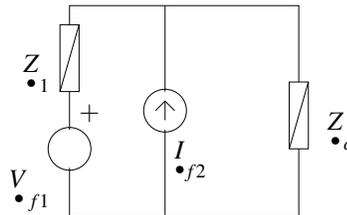
**5.3.1** Calcule la potencia activa disipada por  $Z_{\bullet c}$ .
