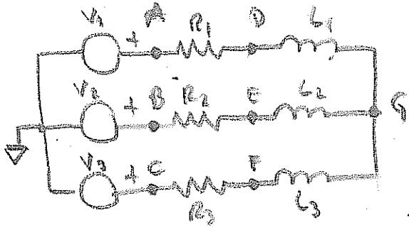
Los voltajes  $V_A = V_1$ ,  $V_B = V_2$ ,  $V_C = V_3$  son conocidos
