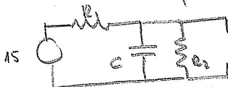
Por tanto el condensador se carga a  $N_C = \frac{15 \cdot R_2}{R_1 + R_2} + 15 \cdot \frac{2}{3} = 10$
