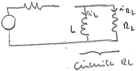
La corriente por el inductor  $\Rightarrow i_L(t) = i_L(\infty) + (i_L(0) - i_L(\infty)) e^{-\frac{t}{\tau}}$
