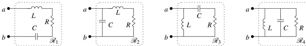
(b) Determine a cuál de las redes anteriores puede corresponder cada uno de los siguientes gráficos de magnitud de la impedancia equivalente en función de la frecuencia  $\omega$ , fundamentando claramente su respuesta (Note que **no** es necesario obtener el valor de las componentes):
