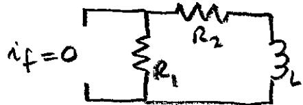
$$i_L(t) = i_L(\infty) + (i_L(t_1) - i_L(\infty)) e^{-\frac{(t-t_1)}{\tau}}$$
