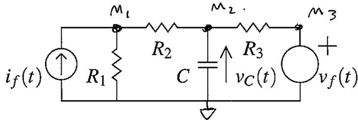
(a) Usando voltaje de Nodos es inmediato  $v_{M3}(t) = v_f(t)$
