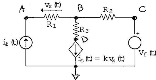
(a) Voltajes de nodos: Note que  $v_c(t) = v_f(t)$  es interdicho
