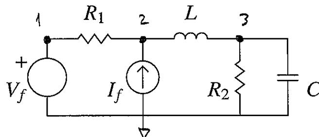
Aplicamos método de voltajes de nodos. Note que  $V_{m1}(t) = V_f$
