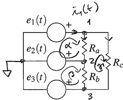
(i) Si se aplica voltajes de nodos, es conveniente como en la figura. De esta forma el voltaje a los otros 3 nodos es directo  $V_{m1}(t) = e_1(t)$ ,  $V_{m2}(t) = e_2(t)$ ,  $V_{m3}(t) = e_3(t)$
