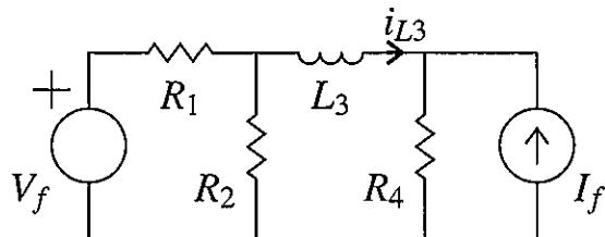
En estado estacionario, dado que las fuentes son constantes, la corriente por el inductor es constante y, por ende, no hay caída de voltaje entre sus terminales: es equivalente a un corto circuito. El circuito equivalente, en estado estacionario es:
