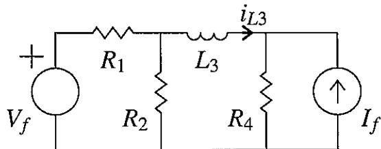
Para determinar la corriente por el inductor podemos primero transformar el resto de la red en un equivalente más simple:
