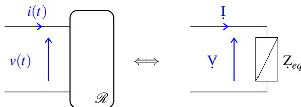
**Problema 14.4** En la red de la figura, determine el equivalente Thévenin en estado estacionario de la red  $\mathcal{R}_1$  desde los terminales  $a - b$ .
