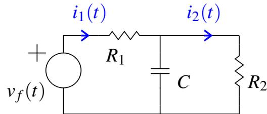
**Problema 14.9** En el circuito de la figura, determine qué valor tiene que tener  $C$  para maximizar el factor de potencia de la red, desde el punto de vista de la fuente.
