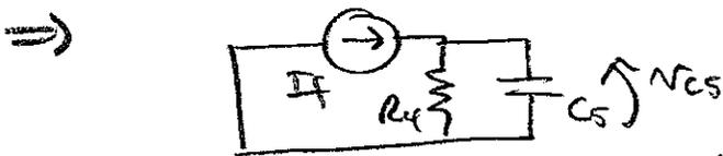
La fuente es constante:  $v_{C5}(t) = v_{C5}(\infty) + (v_{C5}(0) - v_{C5}(\infty)) e^{-t/\tau}$
