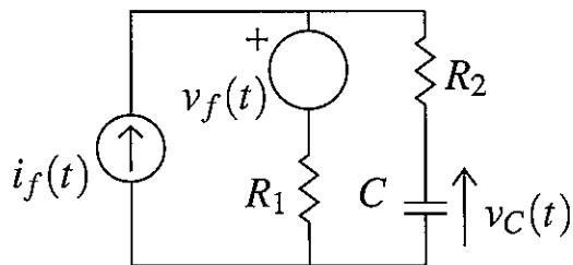
Para calcular  $v_C(t)$  puede aplicarse, por ejemplo, superposición:
