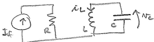
El circuito LC es un oscilador de frecuencia natural  $\omega_{nc} = \frac{1}{\sqrt{LC}}$
