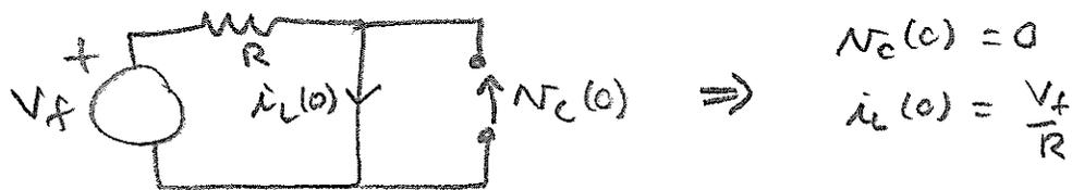
Al apagar la fuente, se debe analizar el siguiente circuito
