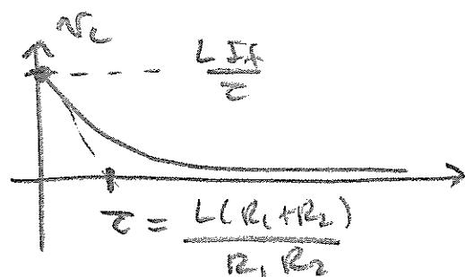
**Problema 1.6 (10 puntos)** En la red de la figura  $R = 1[\text{k}\Omega]$ ,  $C = 1[\mu\text{F}]$ ,  $L = 1[\text{H}]$ ,  $i_f(t) = 1[\text{mA}]$  y las condiciones iniciales en  $t = 0$  son cero. Haga un gráfico cualitativamente correcto del voltaje en el condensador para  $t \geq 0$ .
