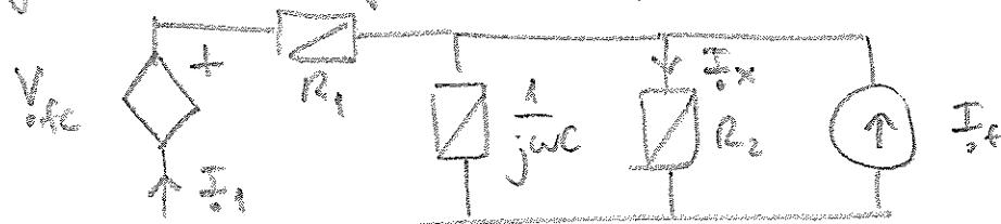
Para el cálculo de potencias se requiere  $V_{fc} \in \mathbb{I}_s$ . Para obtenerlos se pueden usar equivalencias (o alguno de los métodos: nodos o mallas)
