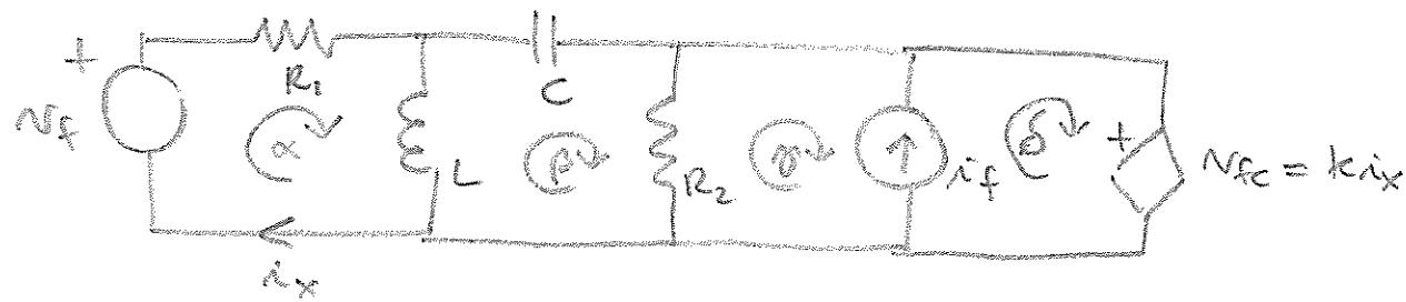
$$\text{LVIK en } \alpha: R_1 i_\alpha + L D(i_\alpha - i_\beta) = v_f$$
