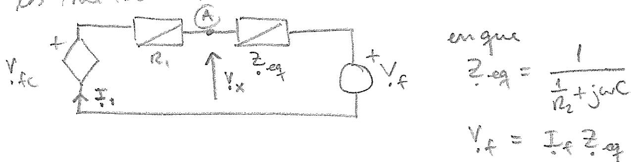
$$\text{y la dependencia de } V_{fc} = k I_x = \frac{k}{R_2} V_x$$
