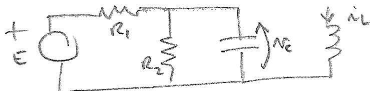
La fuente es constante y el circuito (a  $t = 0$ ) "hace mucho" tiempo  $\Rightarrow N_C(0) = \frac{E \cdot R_2}{R_1 + R_2} = V_0$
