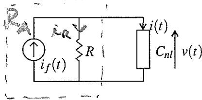
Para determinar el punto de operación, podemos resolver primero suponiendo  $i_f(t) = 2 = i_{eq}$  para determinar  $(i_{eq}, v_{eq})$
