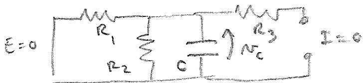
Donde se observa que  $C$  se descarga através de  $R_1 \parallel R_2$
