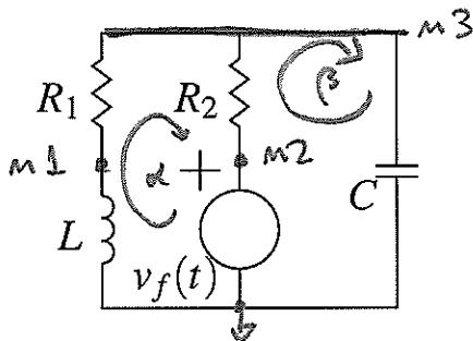
(a) Con las definiciones de la figura aplicamos voltajes de nodo:  $v_{m2}(t) = v_f(t)$  por tanto las incógnitas son  $\{v_{m1}, v_{m3}\}$
