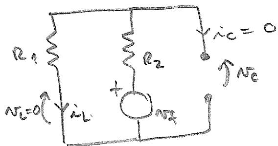
Note que el inductor se comporta como un cortocircuito y el condensador como un circuito abierto.
