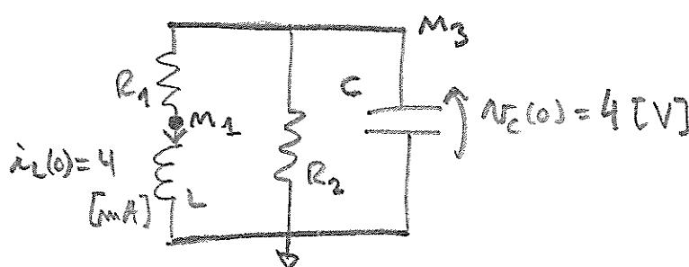
La E.D.O. del voltaje en el condensador se puede obtener (por ejemplo) por voltaje de nodo
