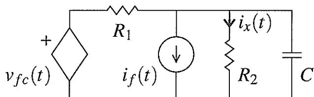
El estado estacionario existe si y sólo si el tránsito divide a las condiciones iniciales desaparece cuando  $t \rightarrow \infty$ . Para tanto, basta analizar la respuesta del sistema a condiciones iniciales, apagando las fuentes independientes:
