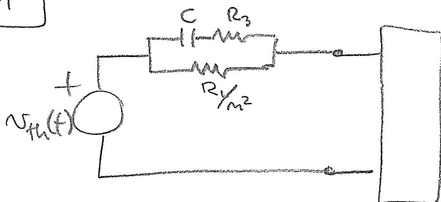
**Problema 6** En la red de la figura,  $v_f(t) = A \cos(\omega t + \alpha)$ . Determine la potencia reactiva entregada por la fuente.
