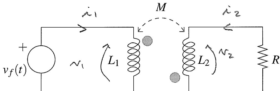
Podemos usar equivalencia "T" de los inductores acoplados:
