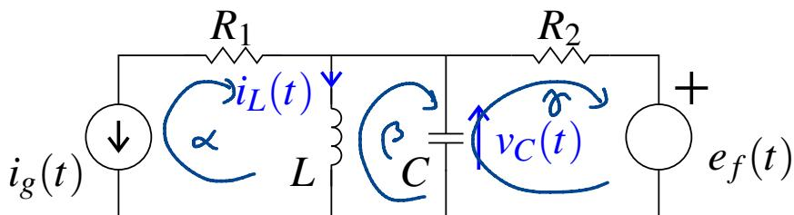
(b) Si se usó corrientes de malla, puede ser más fácil obtener la EDO para  $i_L(t) = i_\alpha - i_\beta = -i_g - i_\beta$
