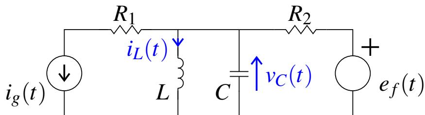
(b) Si se usó voltajes de nodo, es conveniente obtener la ecuación para  $v_C(t) = v_{m2}(t)$ . De hecho, de las ecuaciones planteadas antes, se dispone:
