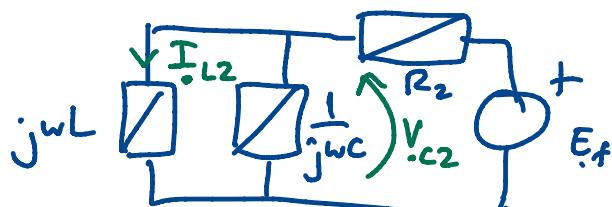
Para calcular  $v_{c2}$  podemos aplicar voltajes de nodos:
