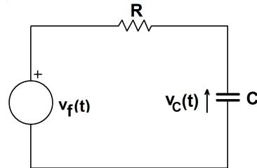
**Problema 1** En la red de la figura, el condensador se encuentra inicialmente descargado  $v_C(0) = 0$  y la fuente es de voltaje es una rampa  $v_f(t) = 2r(t - 1)$ .
