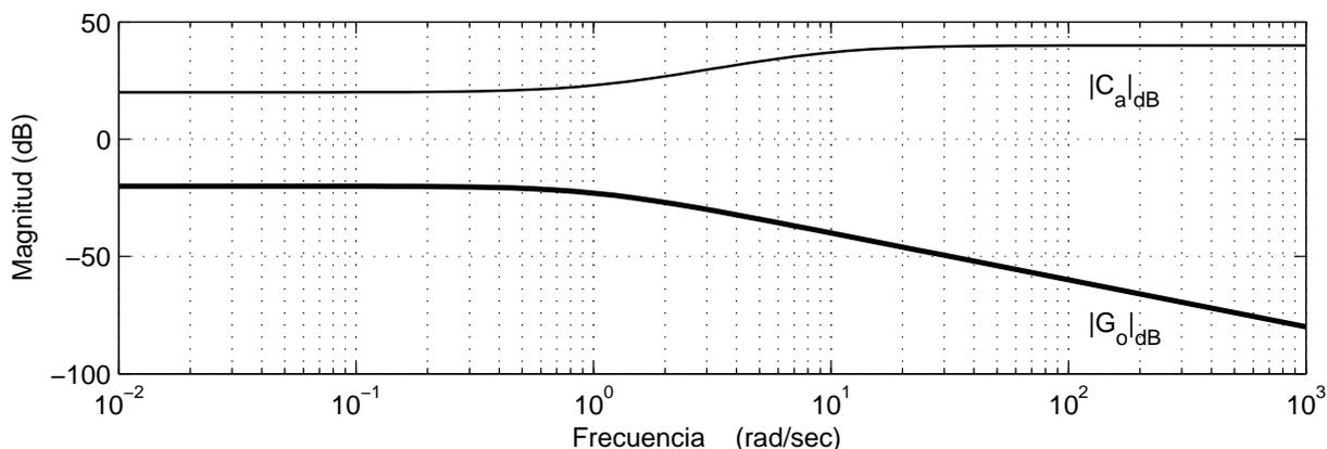
Figura 2: Respuestas en frecuencia de  $G_o(s)$  y  $C_a(s)$ .
