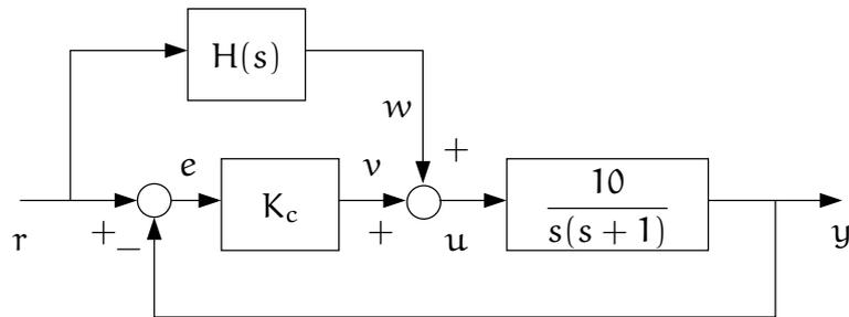
**1.6.1** Suponga que el lazo es internamente estable, que  $H(s)$  es una función de transferencia estable y que  $r(t) = \mu(t)$ . Determine el valor estacionario que alcanza cada una de las señales que se indican en la figura.
