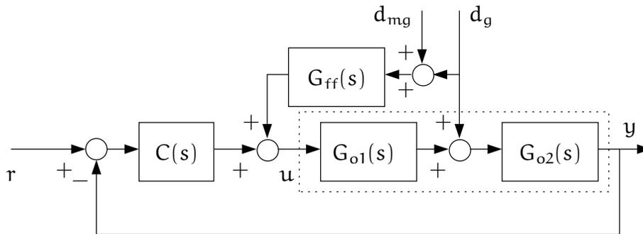
**Problema 1.6 (10 pts.)** En el lazo de control con prealimentación de perturbaciones de la figura determine el efecto del ruido de medición de la perturbación,  $d_{mg}(t)$ , sobre la salida de la planta,  $y(t)$ .
