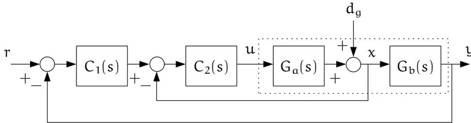
**Problema 1.7 (10 pts.)** En el lazo de control en cascada de la figura determine el efecto de la perturbación  $d_g(t)$  sobre la señal de actuación  $u(t)$ .
