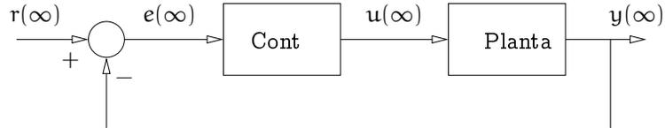
En ella  $r(\infty) = -2$ . Como el controlador tiene ganancia infinita, a frecuencia cero, entonces por estabilidad interna,  $e(\infty) = 0$ , lo cual lleva a  $y(\infty) = -2$ . Por otro lado, la ganancia a continua de la planta no lineal, se calcula haciendo cero las derivadas en el modelo; lo cual lleva a que  $u(\infty) = 8y(\infty) = -16$ .
