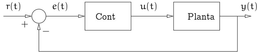
Se sabe que el controlador es lineal con función de transferencia  $C(s)$ , dada por  $C(s) = K(s + 2)/s$ . Se sabe además que la planta es no lineal con modelo de entrada-salida
