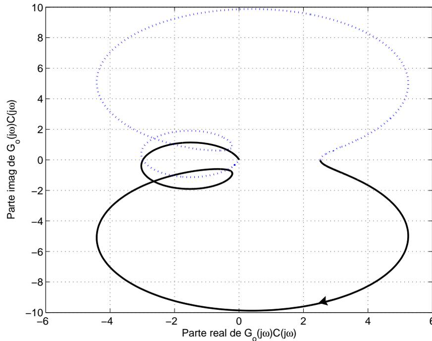
Figura 4: Diagrama polar del lazo abierto (Problema 2.6)
