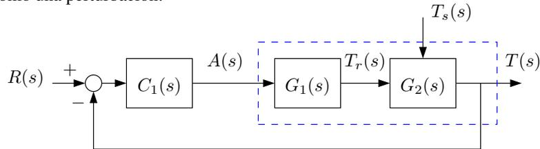
2. Si se mide la variable intermedia  $T_r(t)$  se puede hacer control en cascada, esquema que permite mejorar la dinámica del lazo interno:
