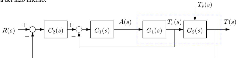
3. Si se mide  $T_s(t)$  se puede implementar un esquema con prealimentación de la perturbación, el cual permite mejorar la compensación de perturbaciones del sistema de control si  $H_f$  se elige apropiadamente:
