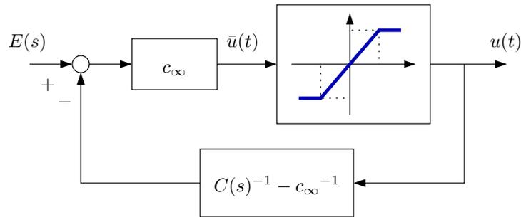
Los bloques lineales se calculan a partir de  $C(s)$ . El primero de ellos, es un bloque de ganancia  $c_\infty = C(\infty)$  y el segundo es un bloque dinámico de función de transferencia  $[C(s)]^{-1} - [c_\infty]^{-1}$ , donde
