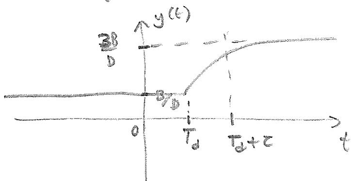
**Problema 1.2** La figura izquierda muestra la respuesta a un escalón unitario  $\mu(t)$  de una planta (lineal e invariante en el tiempo). Determine, si es posible, un controlador de lazo abierto que permita obtener una respuesta a un escalón unitario de referencia como la de la figura derecha.
