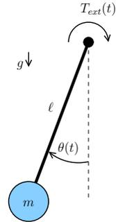
1. Escoja valores para  $0,5 < m \leq 1$ [kg],  $0 < \ell \leq 0,5$ [m],  $0 < C \leq 0,1$ [N m s/rad] y considere como **entrada** del sistema  $u(t) = T_{ext}(t)$  [Nm] : torque externo aplicado en el extremo fijo del péndulo y como **salida**  $y(t) = \theta(t)$  [rad] es el ángulo de desviación respecto a la vertical.
