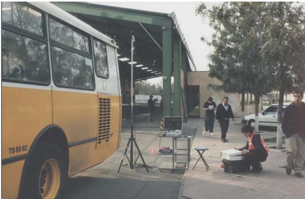
Fig. 5.8 Equipo de medición y micrófono de escape
