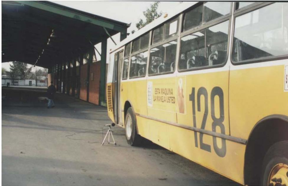
**Fig. 5.9 Micrófono en posición de motor**
